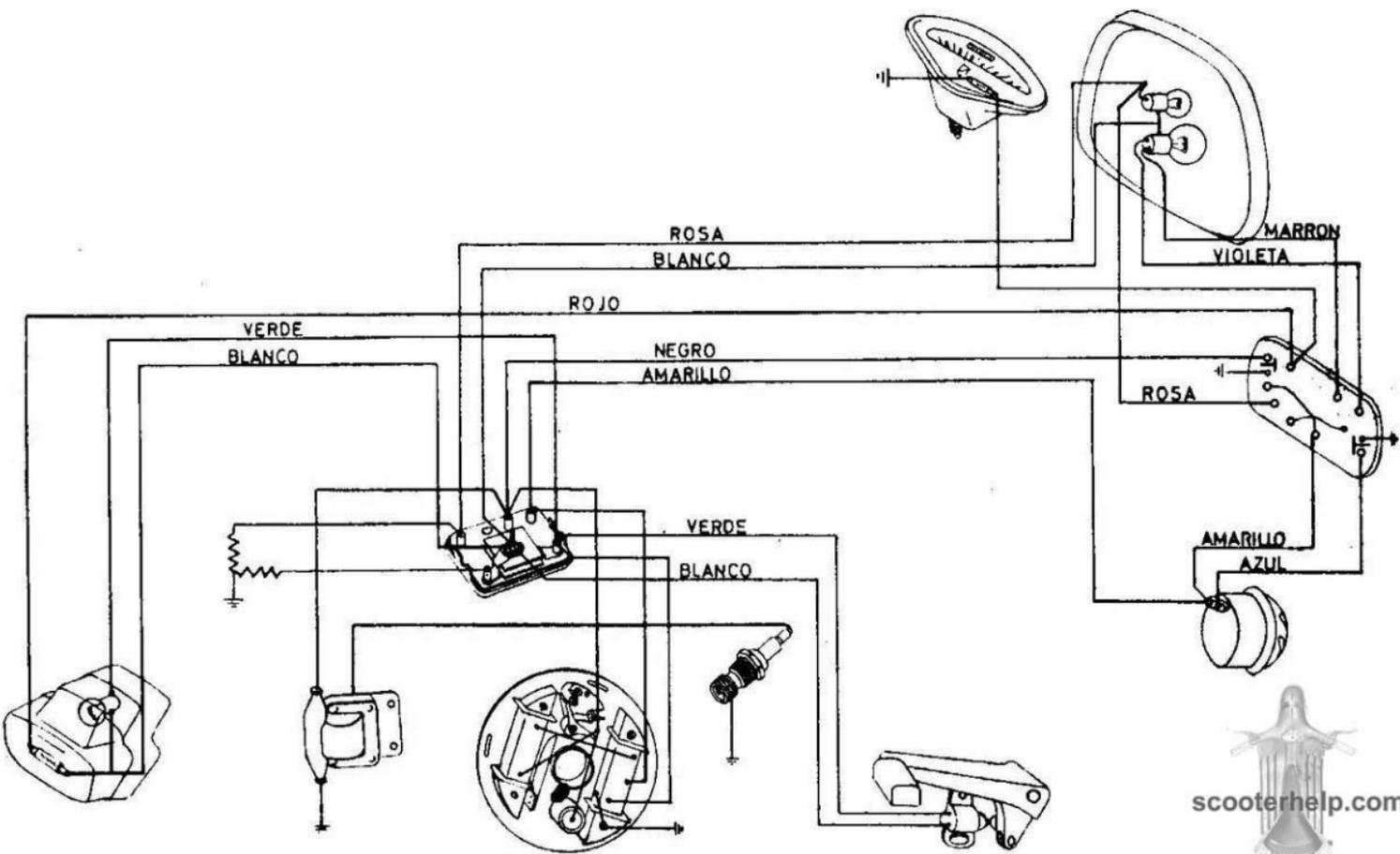
Fig. 2.—Instalación eléctrica en la moto.
