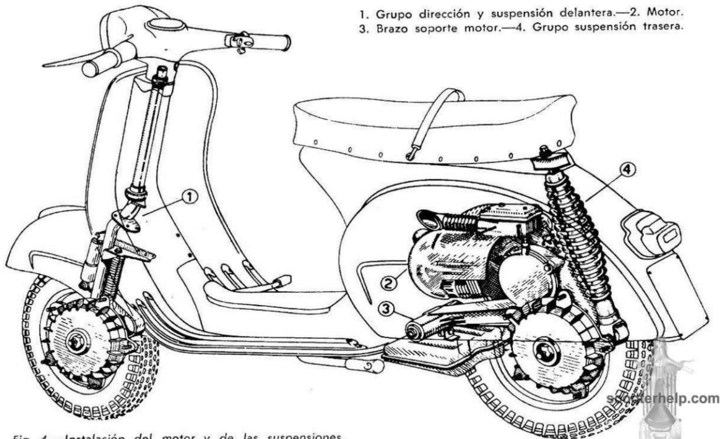
Fig. 4.—Instalación del motor y de las suspensiones.
