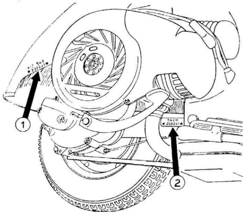
Fig. 3.—Numeraciones sobre el bastidor (1) y el motor (2).
