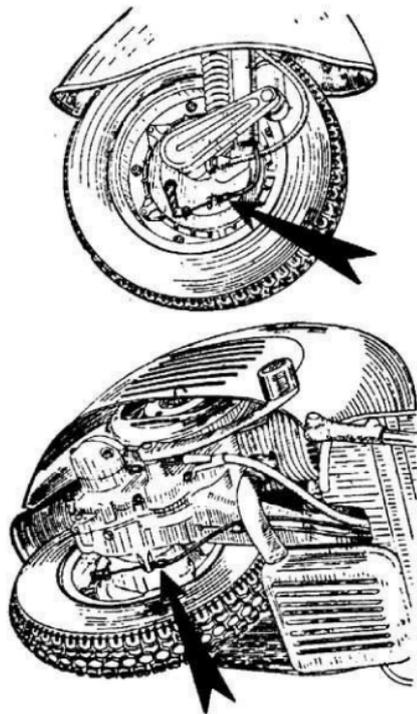
Fig. 13.—Reglaje frenos delantero y trasero.
