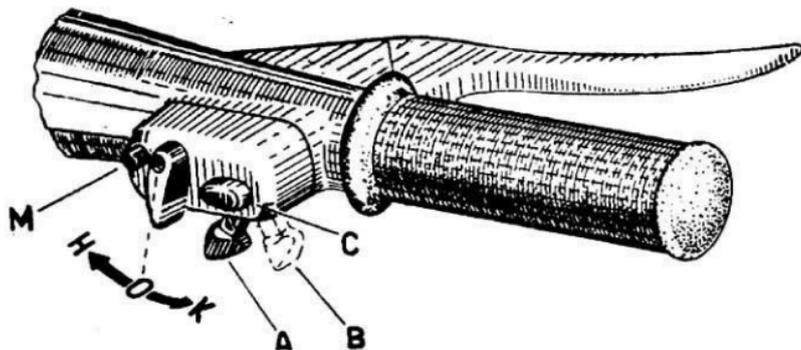
Fig. 9.—Posiciones del conmutador.
