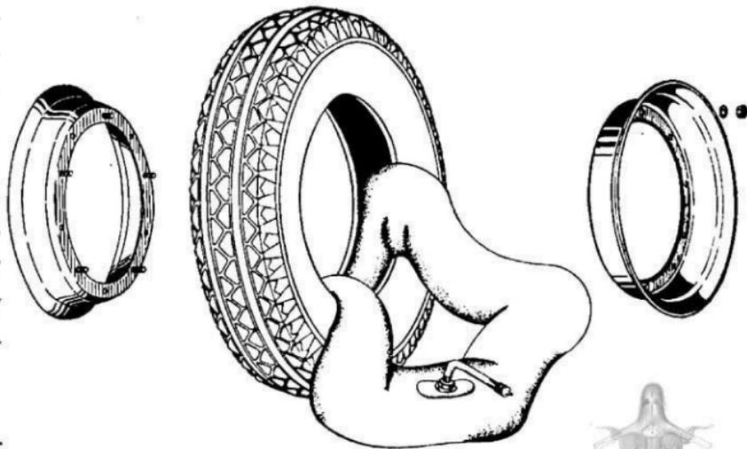
Fig. 12.—Desmontaje neumático.
