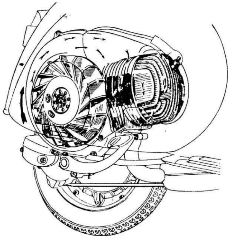
Fig. 6.—Círculo de refrigeración.
