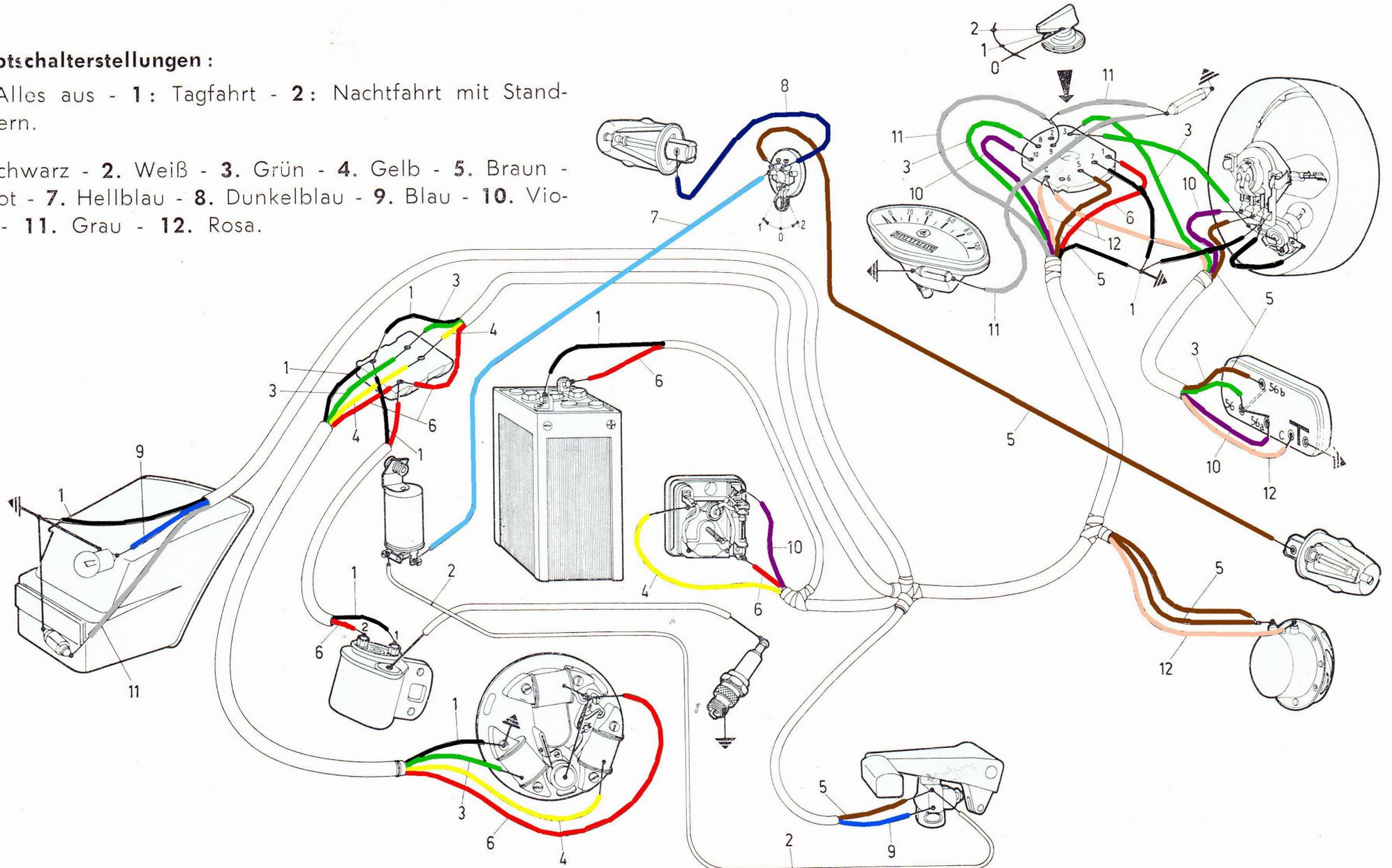
**Birnen:** - Scheinwerfer: 6V - 25/25 W, bilux - 6 V - 5 W Standlicht. - Blinker: 6 V - 18 W. - Tacho: 6 V - 0,6 W - Schlußleuchte: 6 V - 5 W Nummernschild - 6 V - 10 W Stoplicht.
